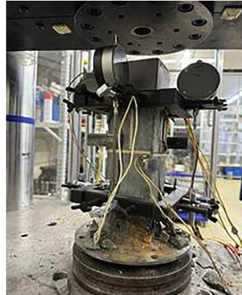
Рис. 2. Призмы 100x100x400 из легкого высокопрочного бетона с встроенными термопарами ТПК 011–05/1
