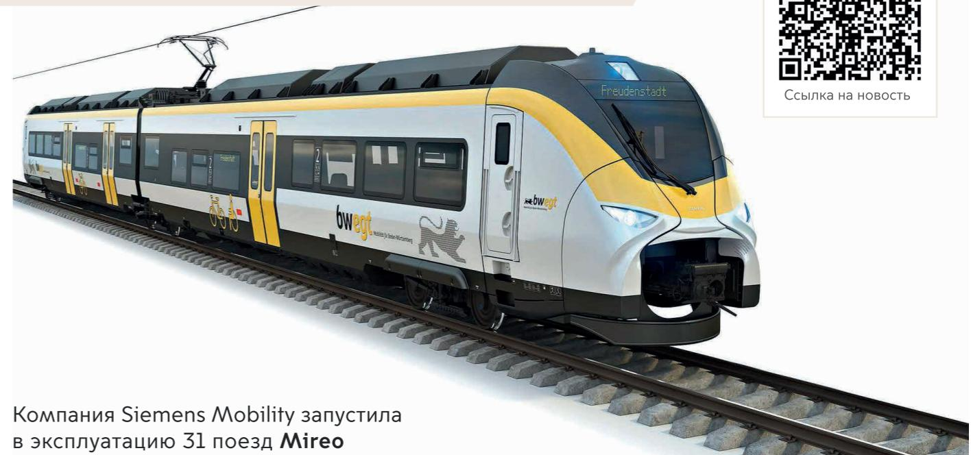
Компания Siemens Mobility запустила в эксплуатацию 31 поезд Mireo Plus B, оснащенный гибридной дизель-аккумуляторно-электрической силовой установкой. Ранее 27 таких поездов было запущено в Германии, а в 2025 году планируются поставки в Данию.
